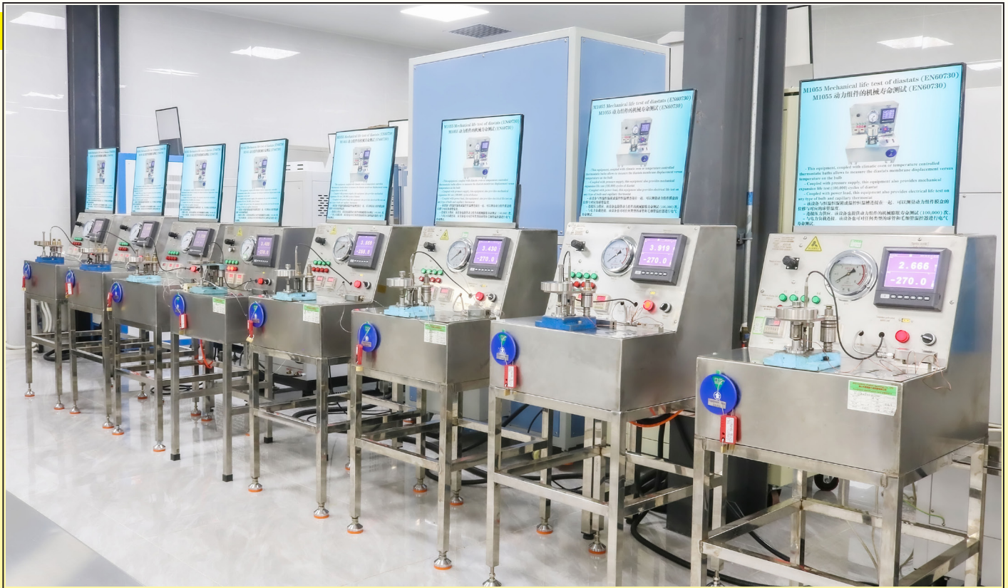
Batterie d'appareils de test de durée de vie de trains thermostatiques. Chaque appareil est équipé d'un enregistreur de paramètres et de nombre ce cycles. (Laboratoire Ultimheat).
